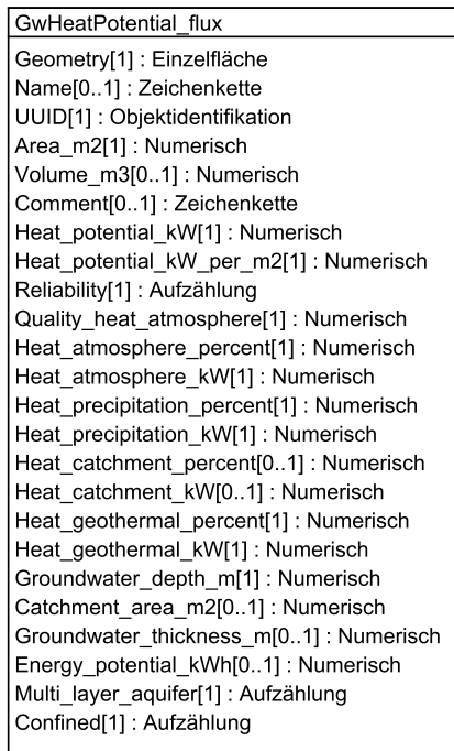
Abbildung 2: UML-Klassendiagramm mit Kardinalitäten und Datentypen
